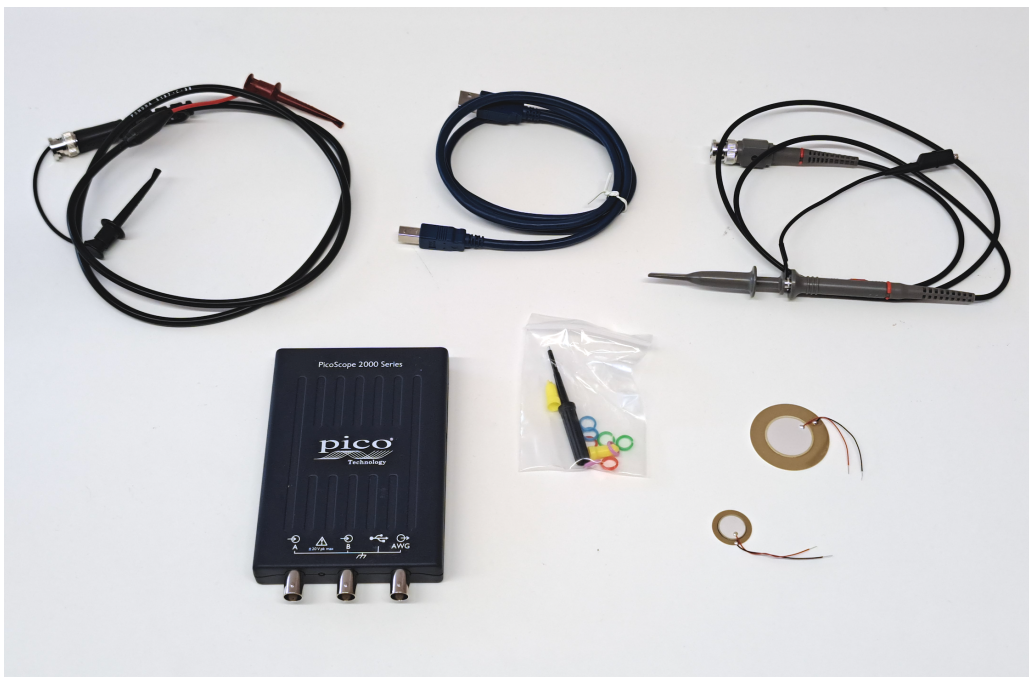
Kuva 1. Valokuva harjoituksessa käytettävästä tietokoneen avulla ohjattavasta oskilloskoopista, johdoista, mittapäiden säätämiseen liittyvästä työkalusta ja kahdesta pietsosähköisestä värähtelijästä.
