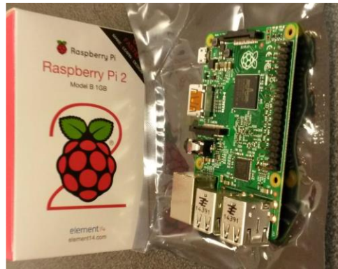
Kuva 6.5. Esimerkki tietokoneesta käytännössä (Raspberry Pi 2).
