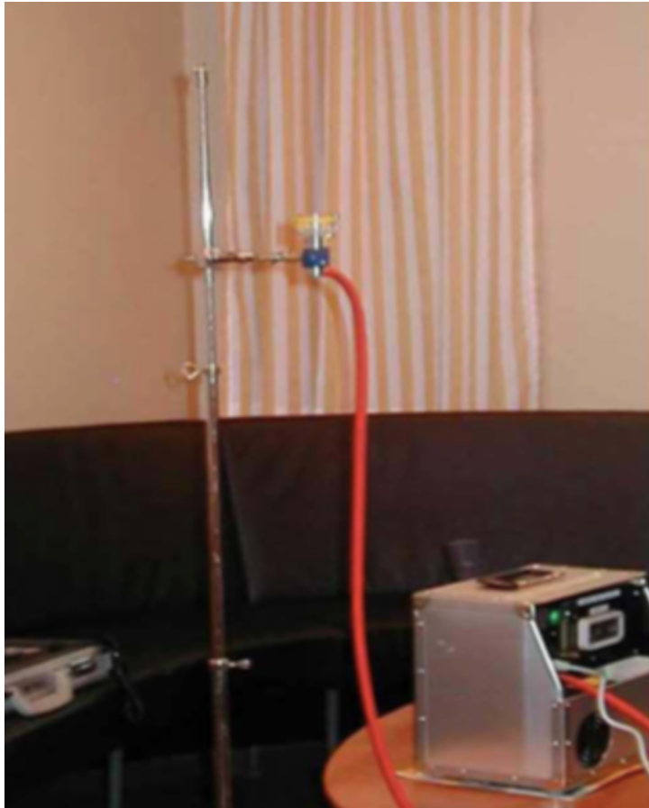
Kuva 6 Ilmanäytteenottolaitteisto (Kovanen et al., 2006)
