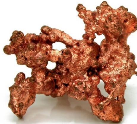
Kupari T_m 1084°C mutta kuparioksidi pelkistyy \approx 900^\circ\text{C} Jalo(hko) metalli
