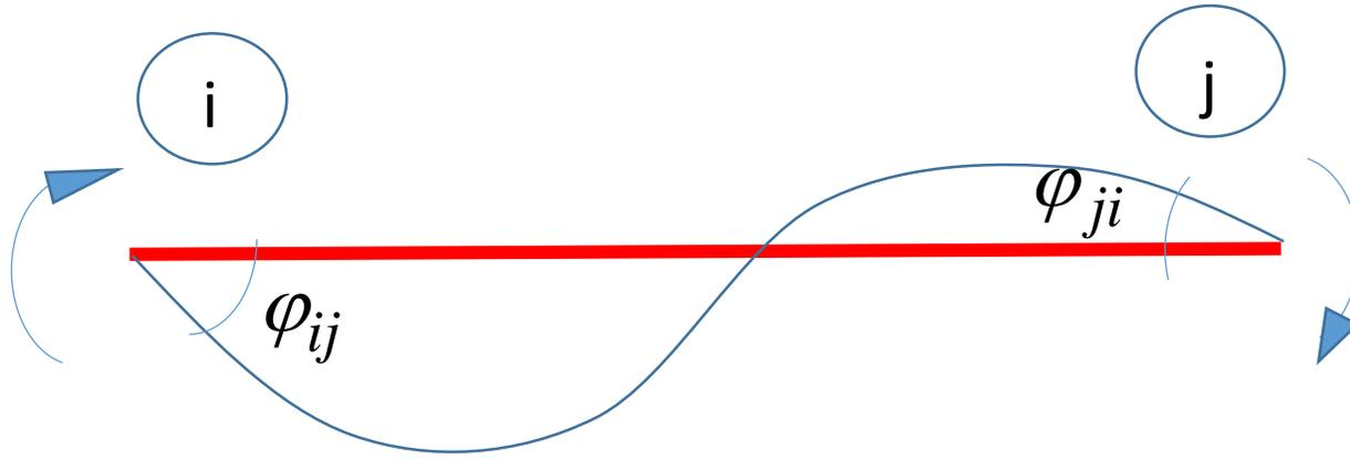
$$\begin{cases} M_{ij} = A_{ij}\varphi_{ij} + B_{ji}\varphi_{ji} - C_{ij}\psi_{ij} + (MK)_{ij} \\ M_{ji} = A_{ji}\varphi_{ji} + B_{ij}\varphi_{ij} - C_{ji}\psi_{ji} + (MK)_{ji} \end{cases} \quad \begin{cases} A_{ij} = A_{ji} = \frac{2\Psi(kL)}{4\Psi^2(kL) - \Phi^2(kL)} \frac{6EI}{L} \\ B_{ij} = B_{ji} = \frac{\Phi(kL)}{4\Psi^2(kL) - \Phi^2(kL)} \frac{6EI}{L} \\ C_{ij} = A_{ij} + B_{ji} \end{cases}$$
