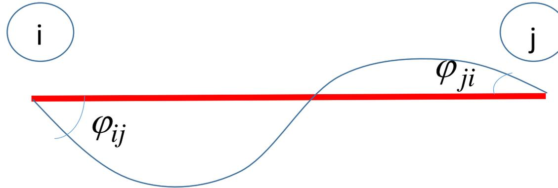
$$\begin{cases} \varphi_{ij} = \frac{L}{3EI} \Psi(kL) M_{ij} - \frac{L}{6EI} \Phi(kL) M_{ji} + \psi_{ij} + \alpha_{ij}^o \\ \varphi_{ji} = \frac{L}{3EI} \Psi(kL) M_{ji} - \frac{L}{6EI} \Phi(kL) M_{ij} + \psi_{ji} + \alpha_{ji}^o \end{cases} \quad \psi_{ij} = \psi_{ji}$$
