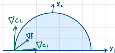
$$\nabla f = \begin{bmatrix} 1 \\ 1 \end{bmatrix} \quad \nabla c_1 = \begin{bmatrix} -2x_1 \\ -2x_2 \end{bmatrix} \quad \nabla c_2 = \begin{bmatrix} 0 \\ 1 \end{bmatrix}$$
