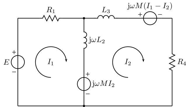
$$\begin{bmatrix} R_1 + j\omega L_2 & -j\omega L_2 \\ -j\omega L_2 & j\omega L_2 + j\omega L_3 + R_4 \end{bmatrix} \begin{bmatrix} I_1 \\ I_2 \end{bmatrix} = \begin{bmatrix} E - j\omega M I_2 \\ j\omega M I_2 - j\omega M(I_1 - I_2) \end{bmatrix}$$
