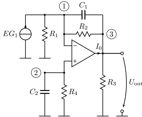
$$\begin{bmatrix} G_1 + G_2 + j\omega C_1 & 0 & -G_2 - j\omega C_1 \\ 0 & G_4 + j\omega C_2 & 0 \\ -G_2 - j\omega C_1 & 0 & G_2 + G_3 + j\omega C_1 \end{bmatrix} \begin{bmatrix} U_1 \\ U_2 \\ U_{\text{out}} \end{bmatrix} = \begin{bmatrix} EG_1 \\ 0 \\ I_0 \end{bmatrix}$$
