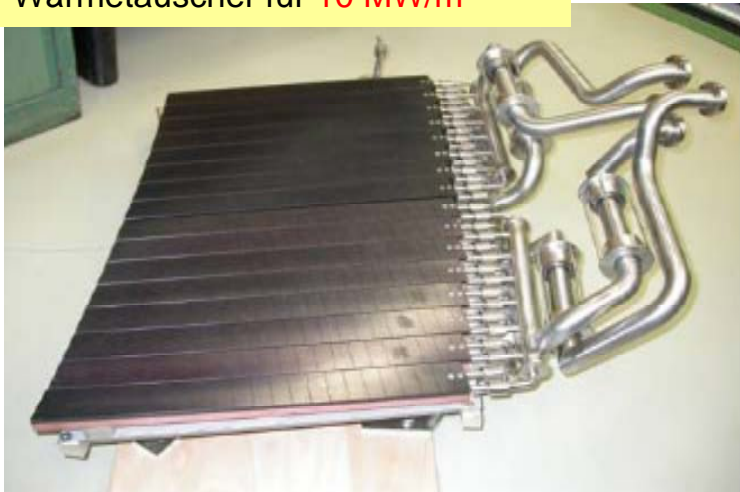
stationär gekühlte Wandelemente Wärmetauscher für 10 MW/m 2
