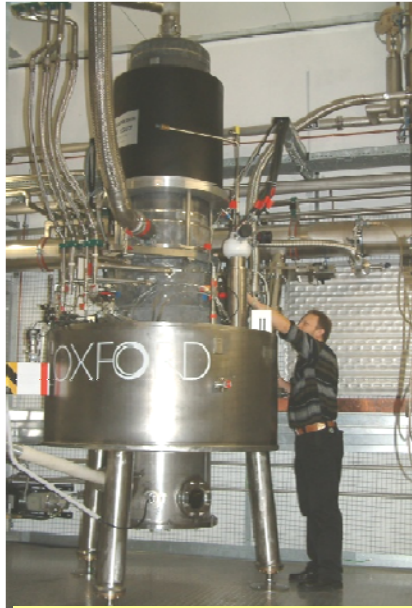
Mikrowellensender: 1 MW cw (2mm) Gyrotron
