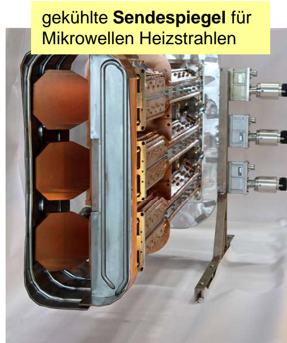
Mikrowellensender: 1 MW cw (2mm) Gyrotron
