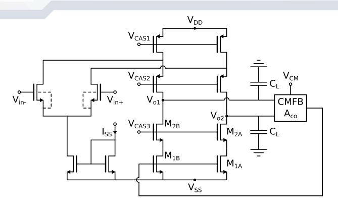
• Gain of common-mode feedback loop:  $A_{LOOP} = -A_{CO} \frac{g_{m1}g_{m2}}{g_{DS1}g_{DS2}} \approx \frac{10^{-3}10^{-3}}{10^{-6}10^{-6}} = 10^{6}$
