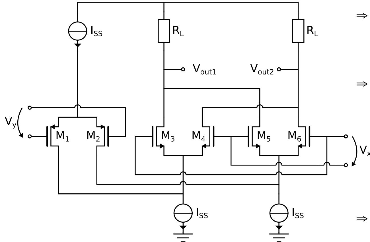
$$I_3 + I_4 = I_{ss} - I_1 = I_2 \quad ; I_1 + I_2 = I_{ss}$$
