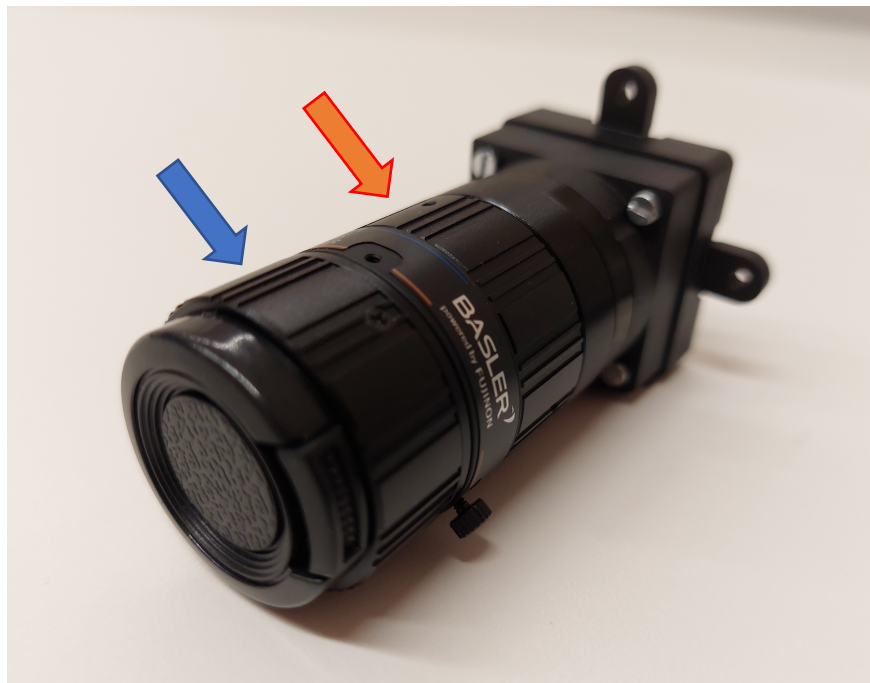
Kuva 1. Valokuva harjoituksessa käytettävästä kamerasta ja objektiivilinsistä. Tarkennusrenkas näkyy etualalla (sininen nuoli) ja apertuurirenkas objektiivin puolivälissä (oranssi nuoli).
