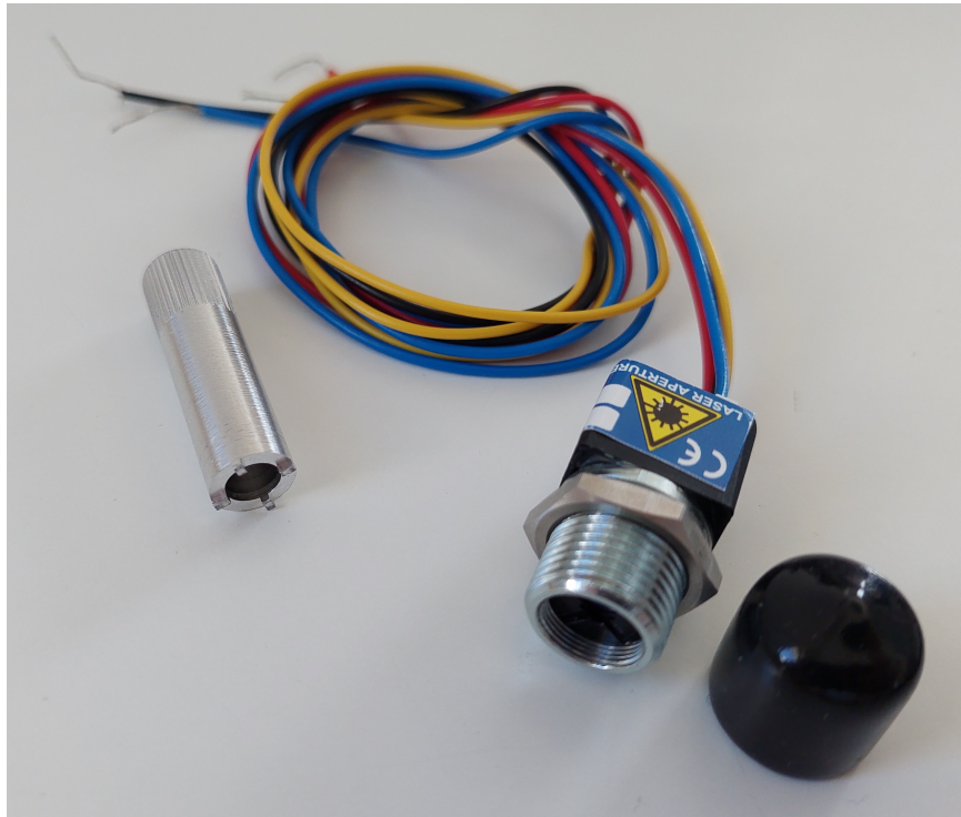
Kuva 4. Valokuva Tehtävässä 3 käytettävästä diodilaserista ja sen valmistajan toimittamasta pienestä metallisesta työkalusta.
