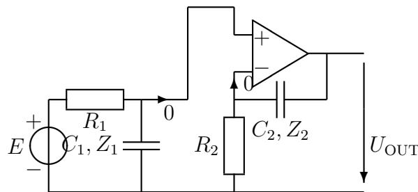
$$V_+ = V_- \Rightarrow \frac{Z_1}{R_1 + Z_1} \cdot E = \frac{R_2}{R_2 + Z_2} \cdot U_{OUT} \quad (28)$$
