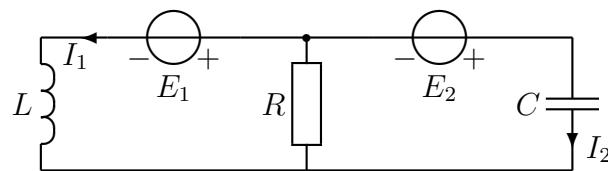
**3. Jännitelähteen luovuttama kompleksinen teho on  $S = 2 + 3j \text{ VA}$ .  $E = 10\angle 0^\circ \text{ V}$ .  $C = 0,005 \text{ F}$ ,  $\omega = 2 \frac{\text{rad}}{\text{s}}$ . Laske  $R$  ja  $L$**
