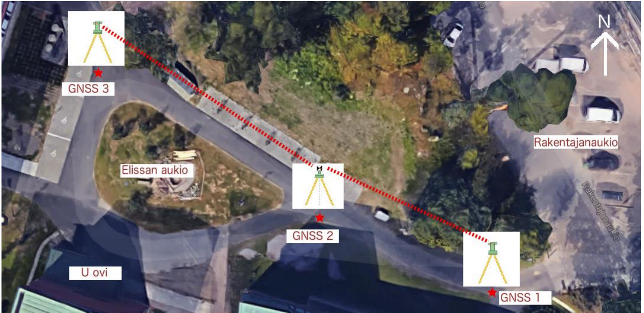
Kuva 3: Asemien määrittäminen pisteille GNSS1 ja GNSS3.
