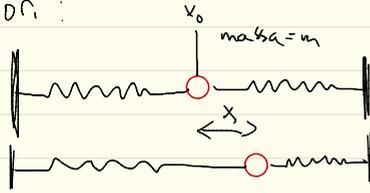
$$\Rightarrow \frac{d^2 x}{dt^2} + \omega_0^2 x^2 = 0, \text{ kerrotaan } \dot{x} = \frac{dx}{dt} : \text{llä}$$
