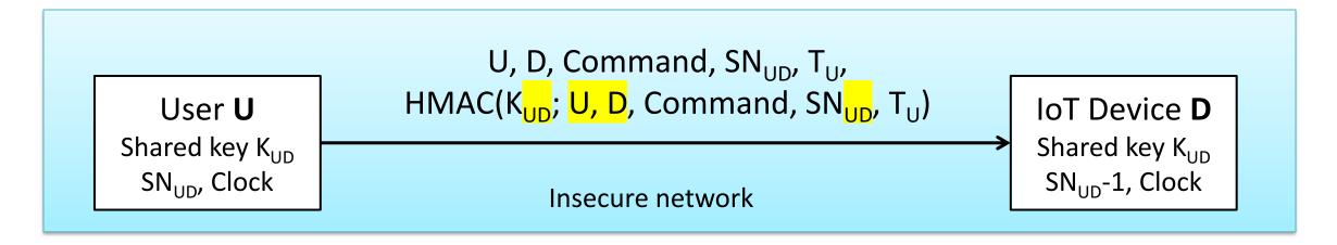
$U \rightarrow D$ : U, D, Command,  $SN_{UD}$ ,  $T_{U}$ , HMAC( $K_{UD}$ ; U, D, Command,  $SN_{UD}$ ,  $T_{U}$ )
