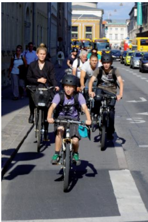
Kuva 6 Poikkeuksellisen kapea, 1,7 metriä leveä pyörätie (City of Copenhagen 2013, s. 13).
