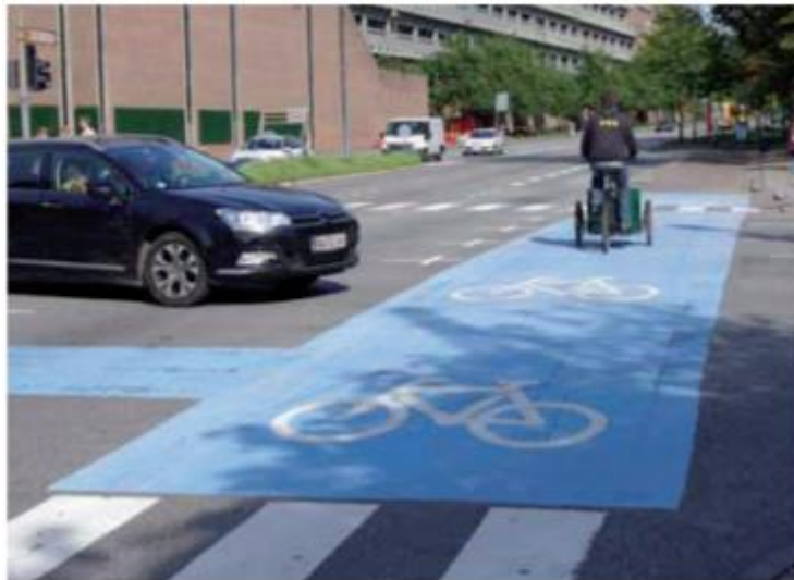
Kuva 5 Sinisellä pinnoitteella korostettu pyöräilijän ylityspaikka (City of Copenhagen 2013, s. 9).
