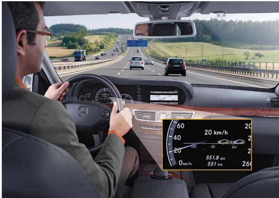
Kuva 2 Vakionopeuden säädin ylläpitää halutun etäisyyden edellä ajavaan. (Lähde: Connolly 2009, kuva1.)
