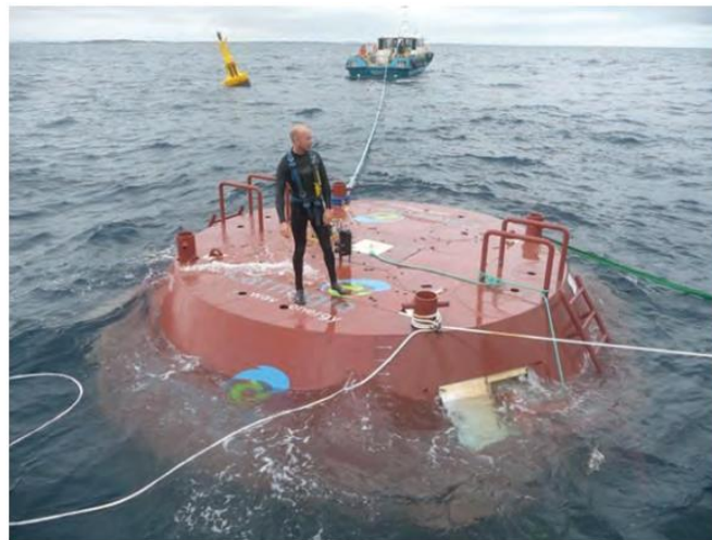
Kuva 2.14 Poijuun perustuvan aaltovoimalan koelaitos.
