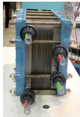
Kuva 2.73 PEM-polttokennon periaatekuva ja toimiva polttokennosto, jossa useita kennoja on kytketty jännitteen nostamiseksi sarjaan. Yhden kennon tuottama jännite on noin voltin luokkaa.
