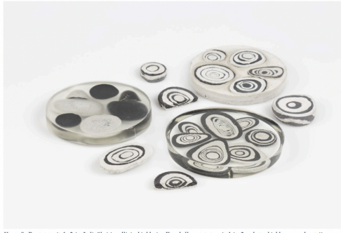
Kuva 9. Prototyypit 1, 2 ja 3, lisäksi irrallisia kiekkoja. Etualalla prototyypit 1 ja 2 valettu kirkkaaseen hartsiin, prototyyppi 3 valettu värjäämättömään laastiin. Kuvaaja: Esa Kapila
