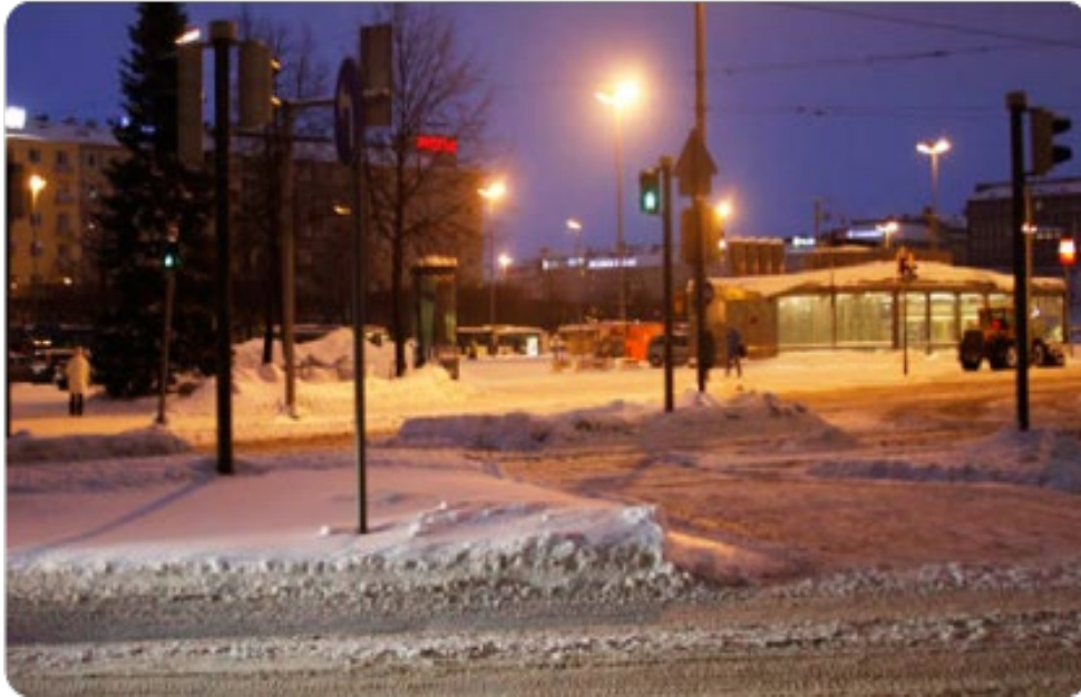
Kuvat 86 ja 87: Yhtenäinen valorivistö osoittaa hyvin kulkusuunnan. Liikenteen alueet on tarpeellista mitoittaa siten, että kunnossapitokalustolla, vaikkakin tarvittaessa pienehköillä laitteilla, pystytään hyvin huolehtimaan myös lumenaurauksesta.
