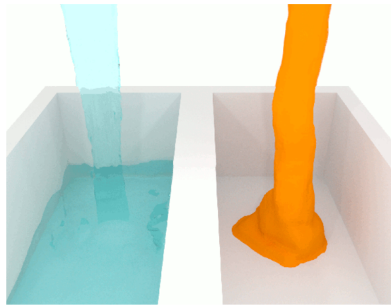
Kuva 5.4: Viskositeetin vaikutus nesteen liikkeeseen. Vasemmalla olevan nesteen viskositeetti on pieni, oikealla suuri (Kuvakaappaus animaatiosta https://en.wikipedia.org/wiki/Viscosity#/media/File:Viscosities.gif )
