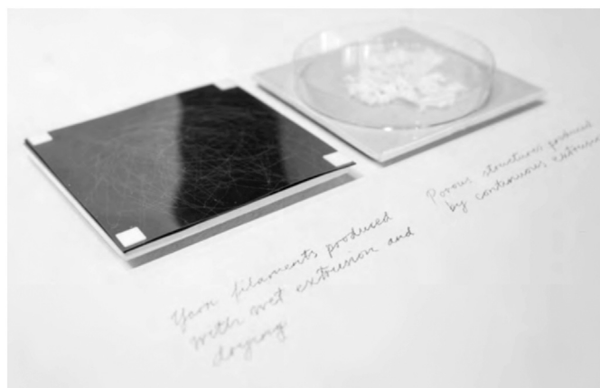
Fig. 13. Cellulose-based filaments from hydrogel suspensions (Kääriäinen et al., 2015).
