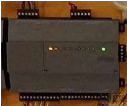
Figure 4.2.1 - 1. NRIO I/O module
