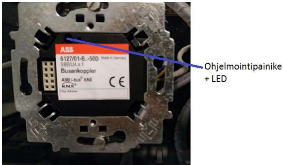
Kuva 9. ABB 6127/01-500 kytkin painonapit irrotettuna.
