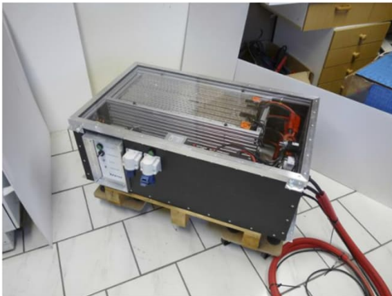
Ensimmäinen. Venekäyttöön rakennetussa 19 kWh akkupaketissa on myös vaihtovirran ulosotto. KRAVEE
