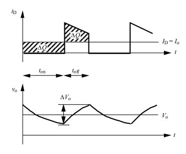
$$\Delta U_o = \frac{\Delta Q}{C} = \frac{I_o D T_s}{C} = \frac{U_o}{R} \frac{D T_s}{C}$$
