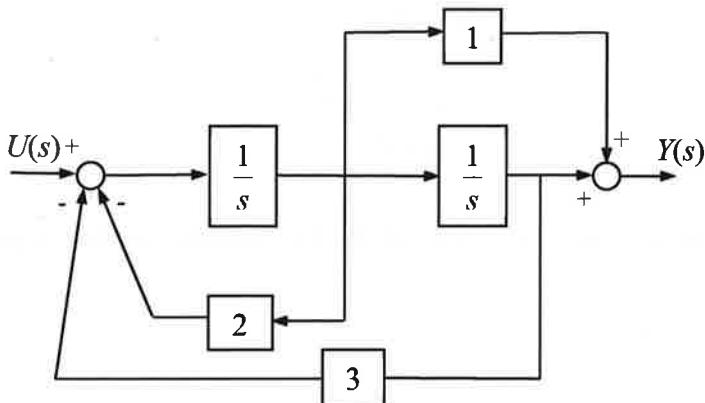
2. Olkoon epästabiili prosessi  $G(s) = \frac{1}{s-1}$ . Käytetään negatiivista takaisinkytkentää ja säättäjää  $K_P \frac{1+T_i s}{T_i s}$ , jossa viritysparametrit  $K_P$  ja  $T_i$  ovat positiivisia vakioita.
