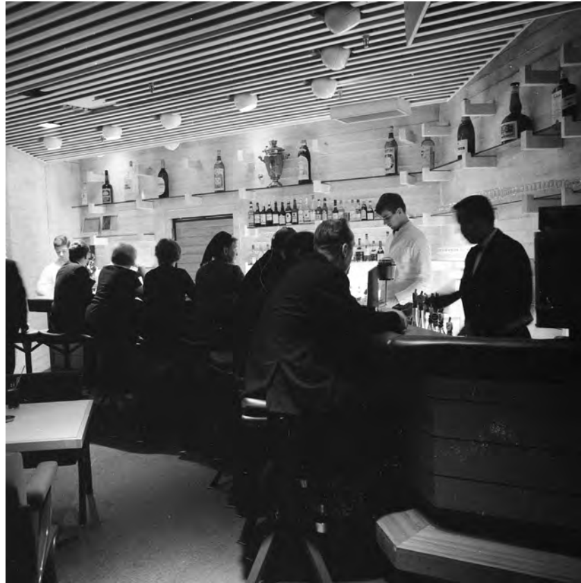
PTK-kabinetissa oli baaritiski ja betonikonsolien kannattamat lasihyllyt.
