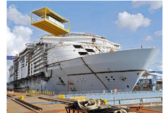
Ready made cabin-module. Image credit Piikkio Works
