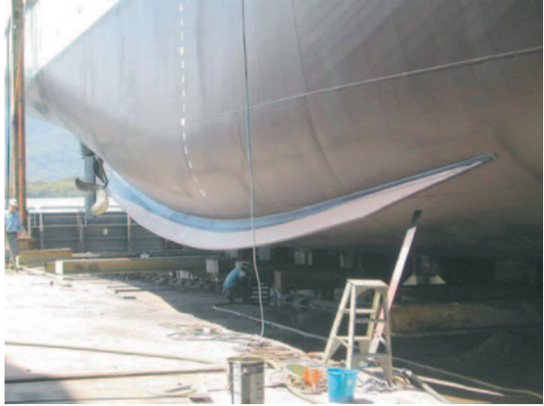
Fig. 2.52 Bilge keel on a tug boat
