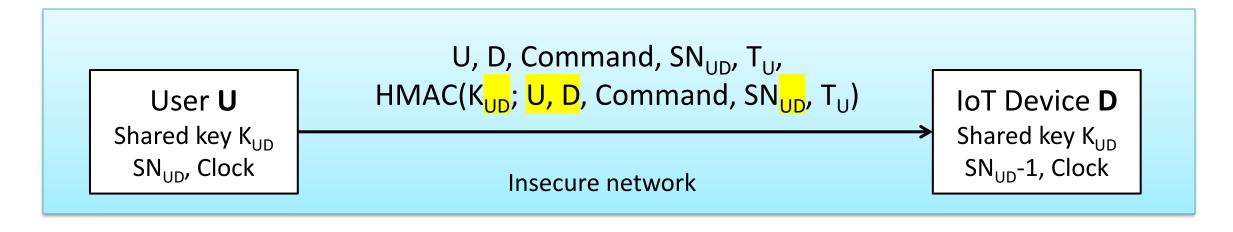
$U \rightarrow D$ : U, D, Command,  $SN_{UD}$ ,  $T_{U}$ , HMAC( $K_{UD}$ ; U, D, Command,  $SN_{UD}$ ,  $T_{U}$ )
