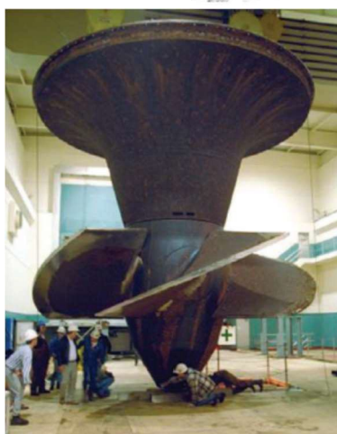
Kuva 4: Reaktioturbiinin periaate ja siihen perustuva Francis- ja Kaplan turbiinien valokuvat.
