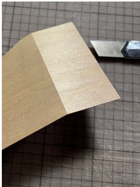
Loivat nurkat on mahdollista tehdä yhdestä palasta. Katkoteräveitsellä tehdään kevyt viilto, jota pitkin viilu taitetaan varovasti.
