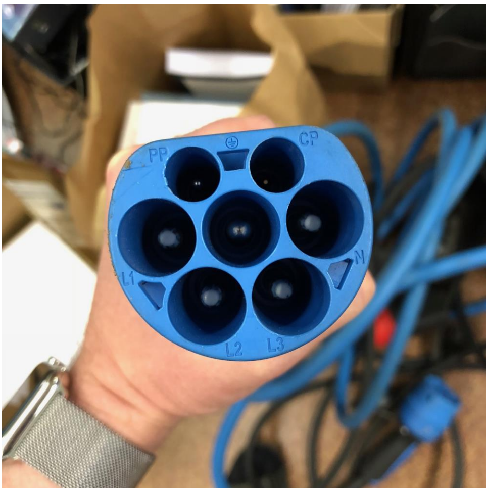
Latauspistotulppa (kytketään pistorasiaan)
