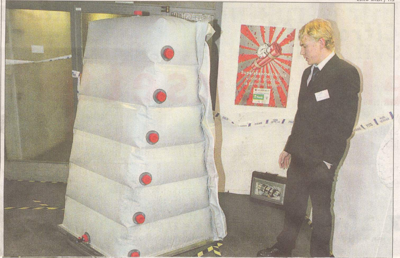
Edessä Superabsorbent-suoja kuljetuskunnossa ja takana pystytettynä. Projektipäällikkö Mikko Reinikaisen takana nurkassa näkyy myös "pommilaukku", jonka räjähdystä varten suoja on pystytetty.
