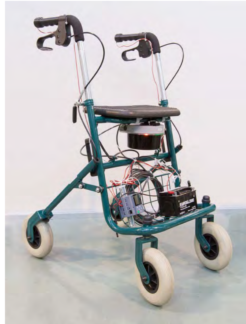
3D-LiDAR asennettuna rollaattoriin. Anturi haluttiin asentaa suojaan paikkaan, eikä se myöskään saanut häiritä käyttäjää.
