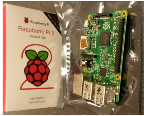
Kuva 6.5. Esimerkki tietokoneesta käytännössä (Raspberry Pi 2).
